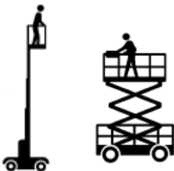
Elévation verticale pouvant être déplacée à partir de la plate-forme en élévation
