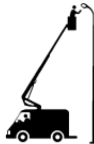
Elévation multidirectionnelle pouvant être déplacée à partir du porteur avec la plate-forme en élévation
