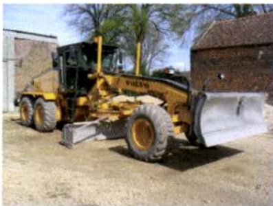
Engins de réglage à déplacement alternatif (niveleuse)
