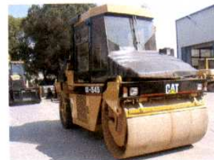
Engins de compactage à déplacement alternatif (compacteur...)
