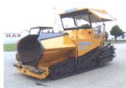
Finisseur (pose des enrobés)
